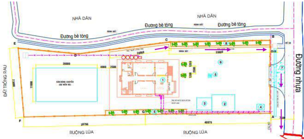
Hình 3.7. Mặt bằng thoát nước mưa
