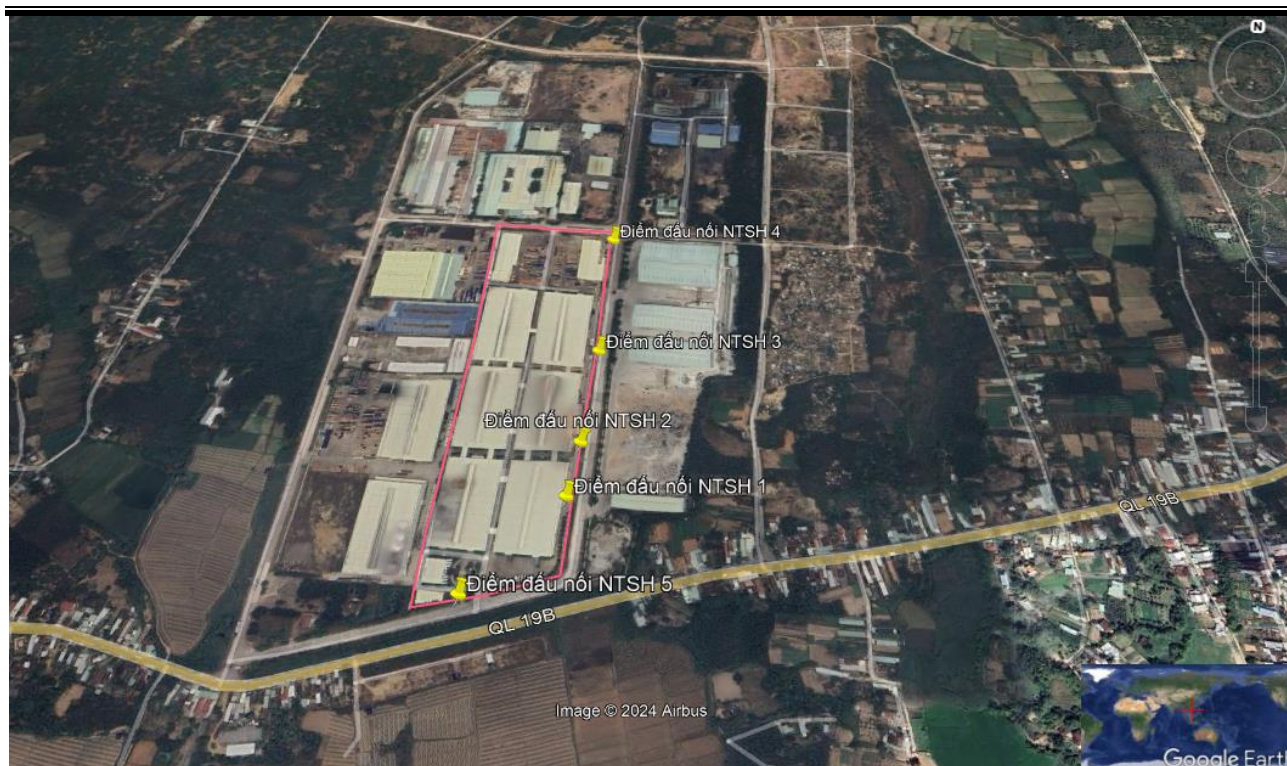
Hình 3. 4: Các vị trí đầu nối nước thải sinh hoạt với hệ thống thu gom nước thải của CCN Cát Nhơn
