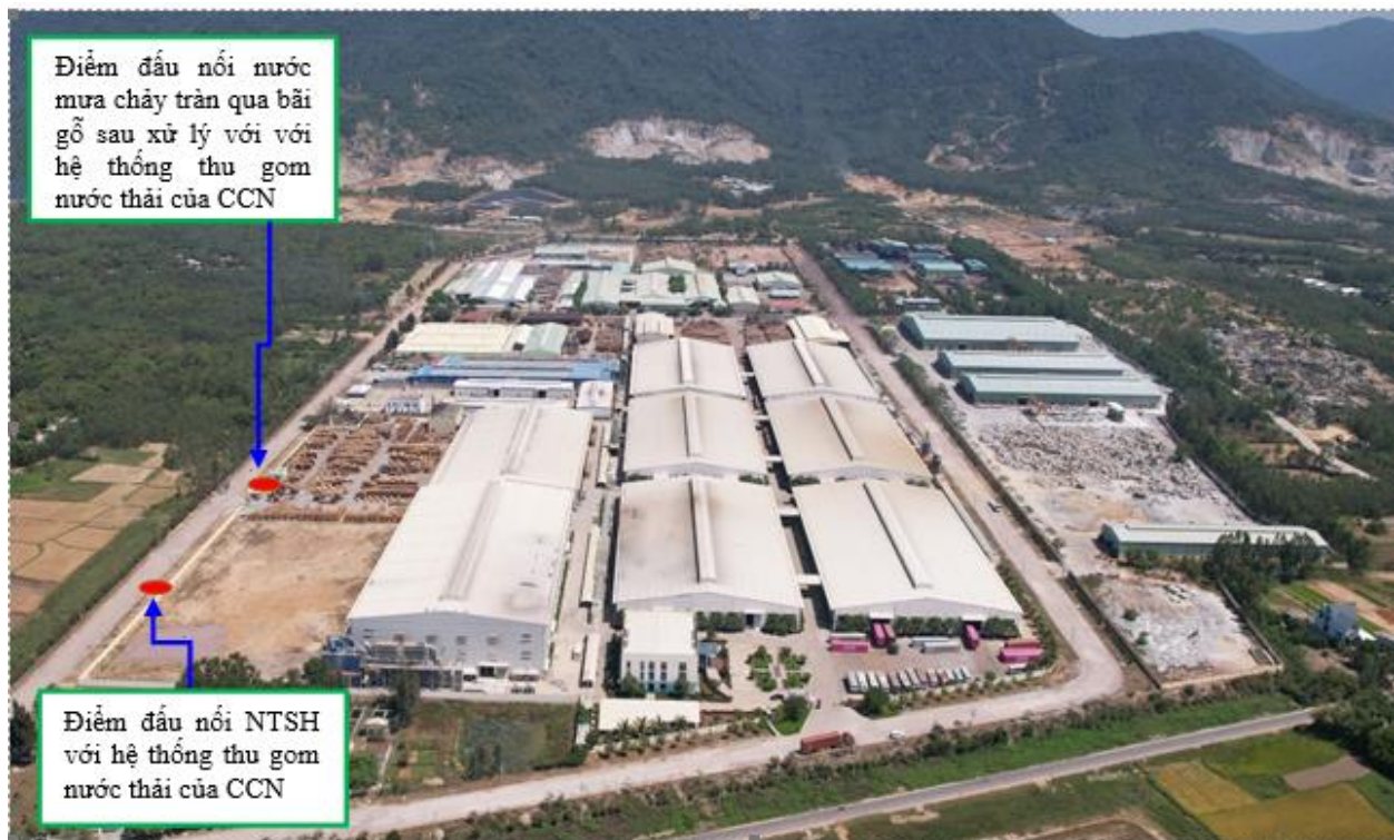
Hình 3.7: Vị trí đầu nổi nước thải sinh hoạt và nước mưa chảy tràn với hệ thống thu gom nước thải của CCN
