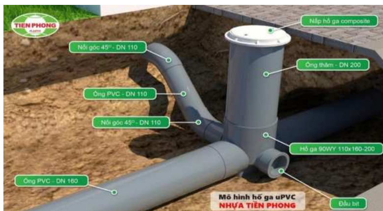
Hình 1.4. Hố ga đầu nối nước thải hộ gia đình
